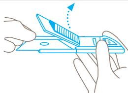
Tenez la lame du côté **non affûté** et utilisez-la pour soulever le cache-lame. Le cache reste en position ouverte.
