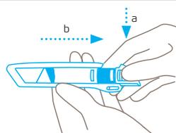
Appuyez sur le bouton de changement de lame et tirez l'insert en plastique vers l'arrière pour le sortir du manche.
