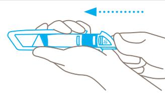
Refermez le cache-lame et repoussez l'insert en plastique dans le manche jusqu'à ce que le bouton de changement de lame fasse un **déclic**.
