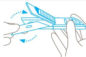
Retirez et retournez ou changez la lame. Veillez à bien réinstaller la lame en la plaçant **exactement** sur l'ergot.
