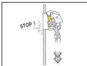
En cas de mouvement brusque (chute, glissade, descente non contrôlée...), l'antichute se bloque sur la corde et immobilise l'utilisateur.
