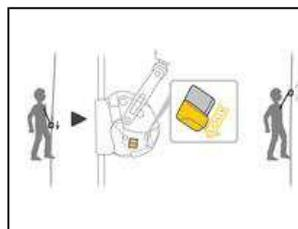
La fonction de blocage intégrée permet à l'utilisateur d'immobiliser l'appareil pour réduire la hauteur de chute.
