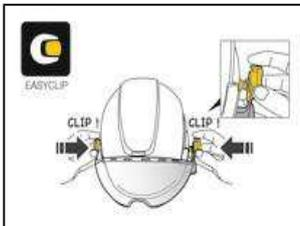
L'installation est simple et rapide, grâce au système d'attache EASYCLIP fourni.
