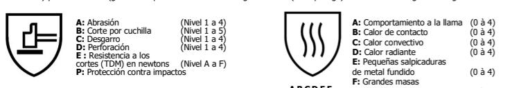
X: Indica que el guante no ha estado sometido al examen o que el método de prueba no parece conveniente a causa de la concepción del guante o del material.
